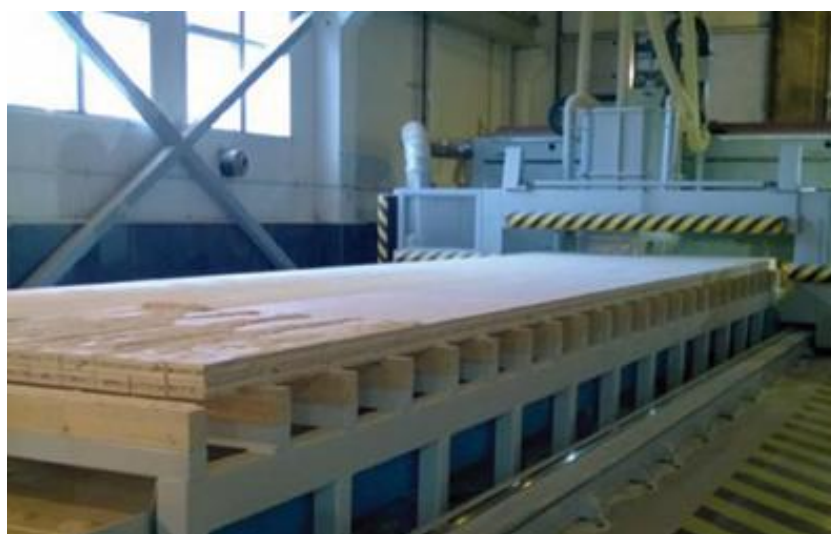
Figura 14 – CNC para corte do CLT
