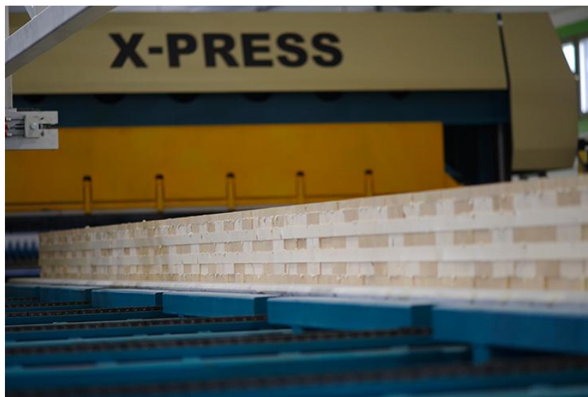
Figura 13 - Prensa Pneumática para CLT
