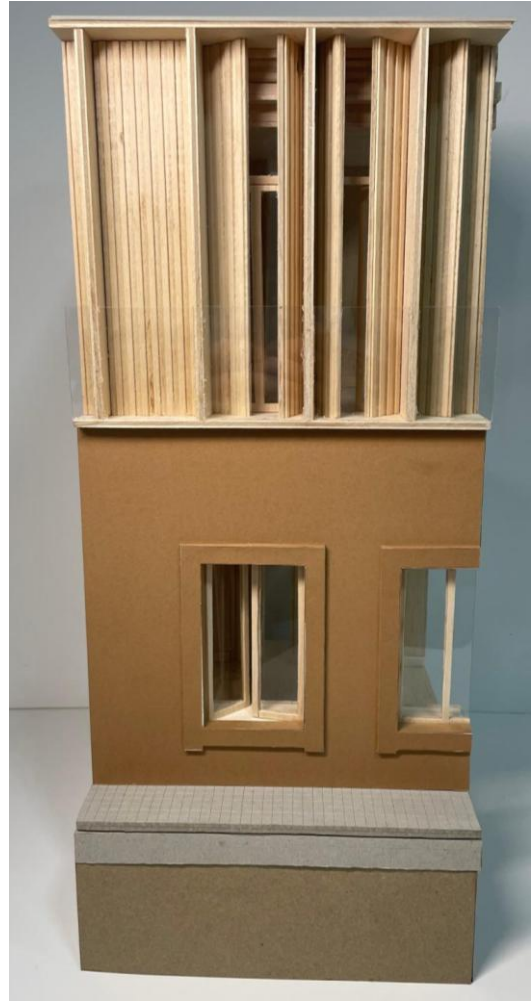
Figura 118 - Maquete Construtiva 1:20 | Proposta
