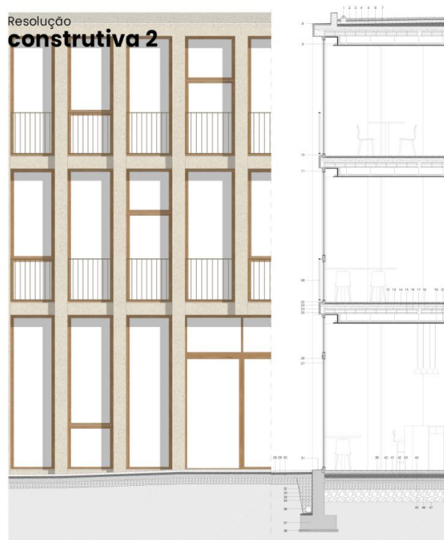
Figura 74 - Resolução construtiva - edifício betão
