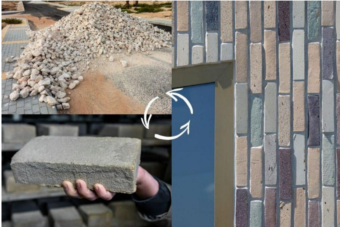
Figura 5 - Ciclo de produção de tijolos a partir de resíduos
