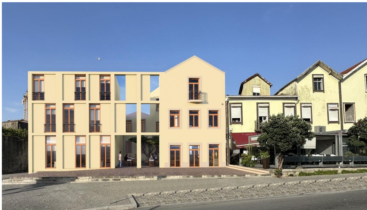
Figura 90- Fotomontagem da frente urbana proposta. A intervenção recompõe a continuidade da fachada das antigas “Casas de Mar”, introduzindo um ritmo coerente de vãos, varandas e planos murários, e abrindo um pórtico que dá acesso direto ao novo pátio público interior. O edifício passa a assumir-se como frente ativa e permeável para o espaço público, em vez de barreira opaca, 2025.
