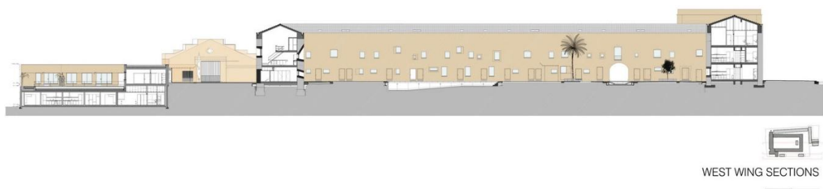
Figura 29- Convento das Bernardas, Tavira- Corte do corpo poente evidenciando o desnível entre o pátio central e a faixa nascente (aproveitado para a banda de habitações), tornando legível a diferença de cota no conjunto 2013.
