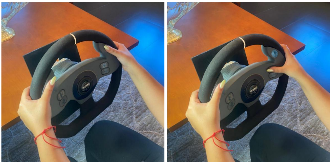
Figura 63. Posicionamento do apoio de polegares (sensores de vibração) e utilização do botão volume (+). Elaborado pela investigadora.
