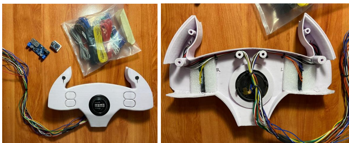
Figura 54. Montagem dos componentes elétricos. Elaborado pela investigadora.
