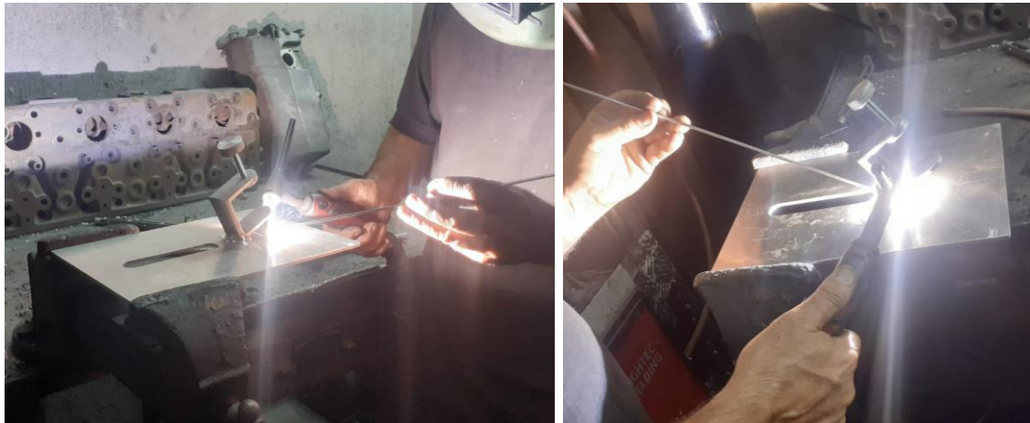
Figura 58. Fase de soldadura. Elaborado pela investigadora.
