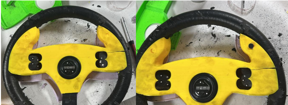
Figura 51. Testes de prototipagem (com defeito)
