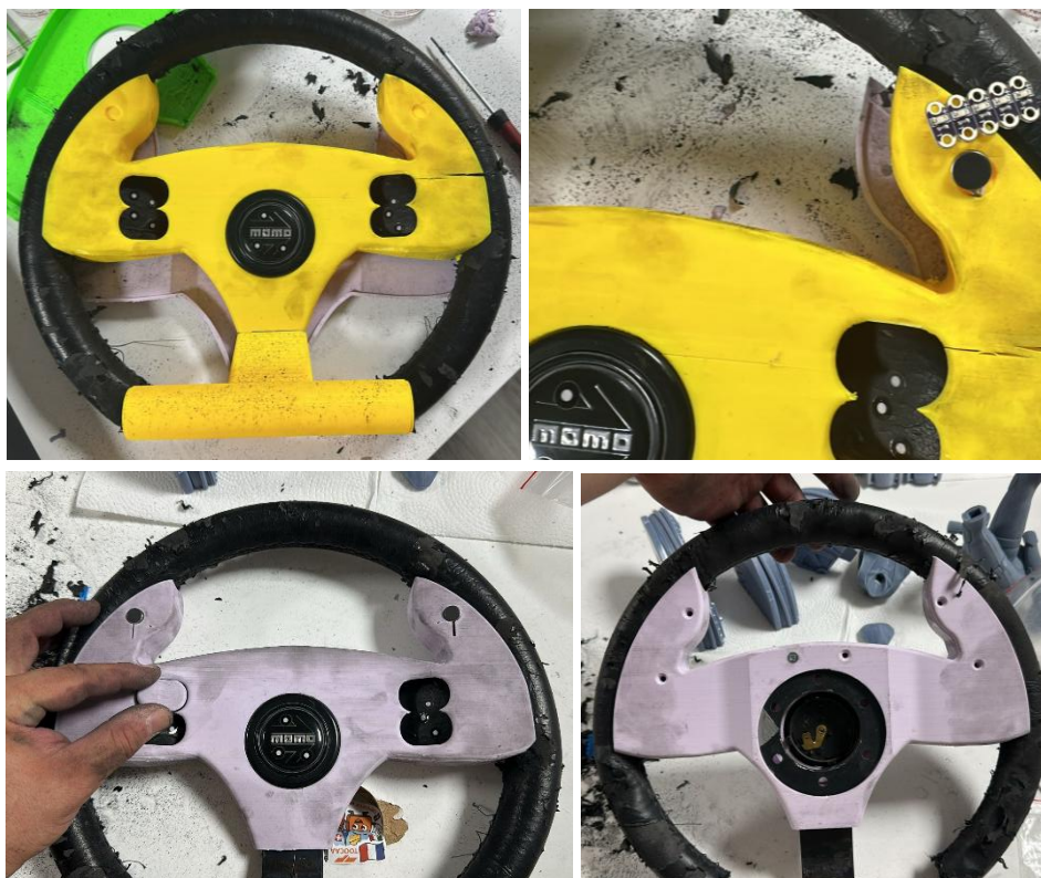
Figura 53. Ajuste e aperfeiçoamento das peças finais. Elaborado pela investigadora.
