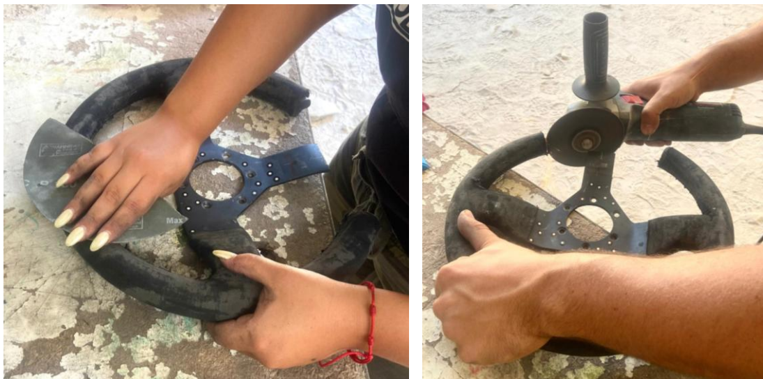
Figura 52. Processo de lixagem e corte. Elaborado pela investigadora.
