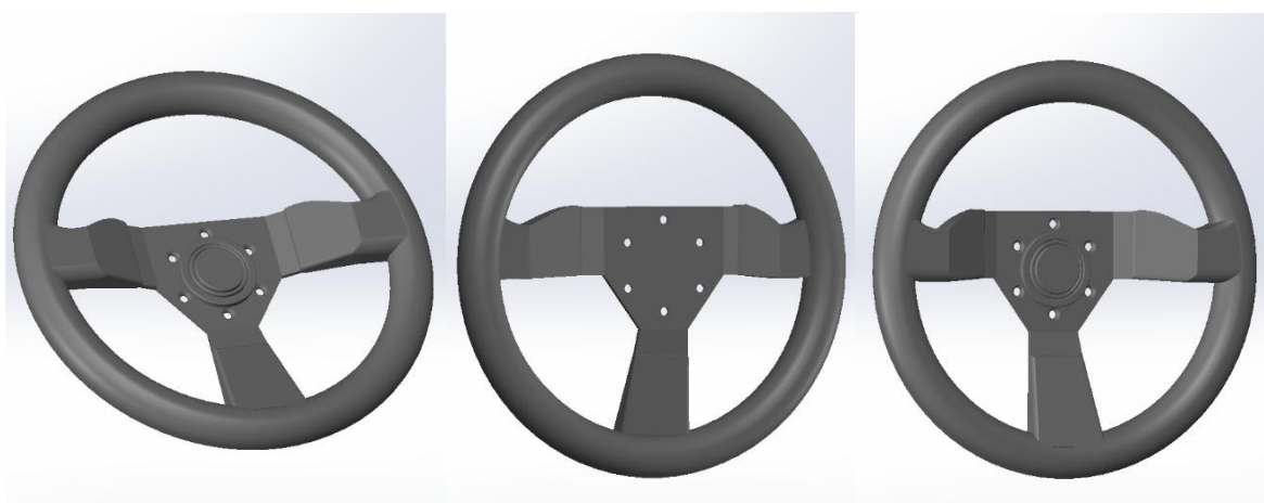
Figura 46. Digitalização do volante através de scanner 3D. Elaborado pela investigadora.
