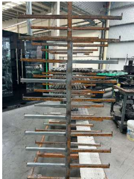
Figura 37 - Carros de fornecimento de reforço para as CNC Schtec 320 e Schtec 360
