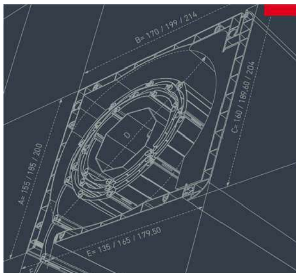
Figura 10 - Caixa de estore e possíveis medidas
