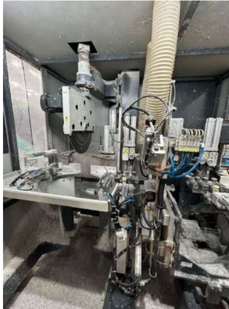
Figura 33 - Ferramentas de corte e mecanização da CNC Schtec 320
