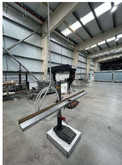
Figura 43 - Máquina de furação manual de apoio à máquina CNC Schtec 360
