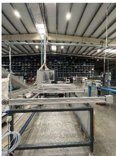
(A) - Posto de colocação de reforço Schtec 320
