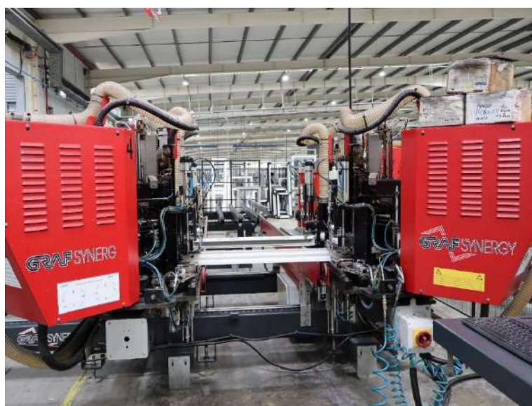
Figura 16 - Máquina de soldar automática de quatro cabeças, Graf (Soldadura)
