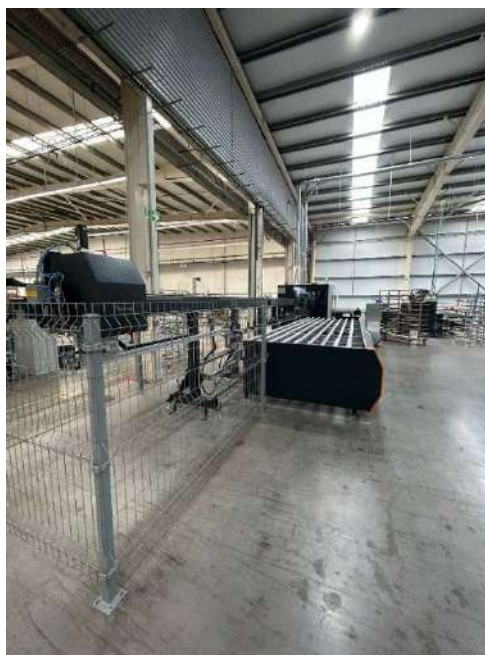
Figura 32 - Tapete de abastecimento da CNC Schtec 360
