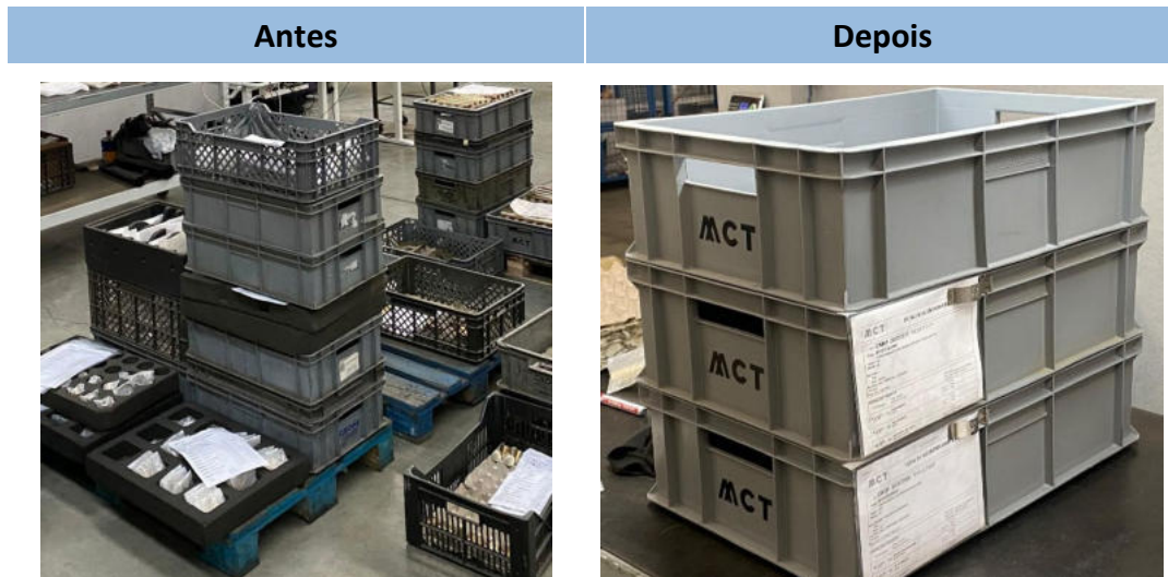
Figura 20 – Comparação entre a situação inicial e final do acondicionamento das peças no setor de acabamento.
