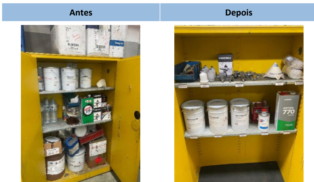
Figura 17 – Comparação da situação inicial do armário de pintura com a organização após os 5S.
