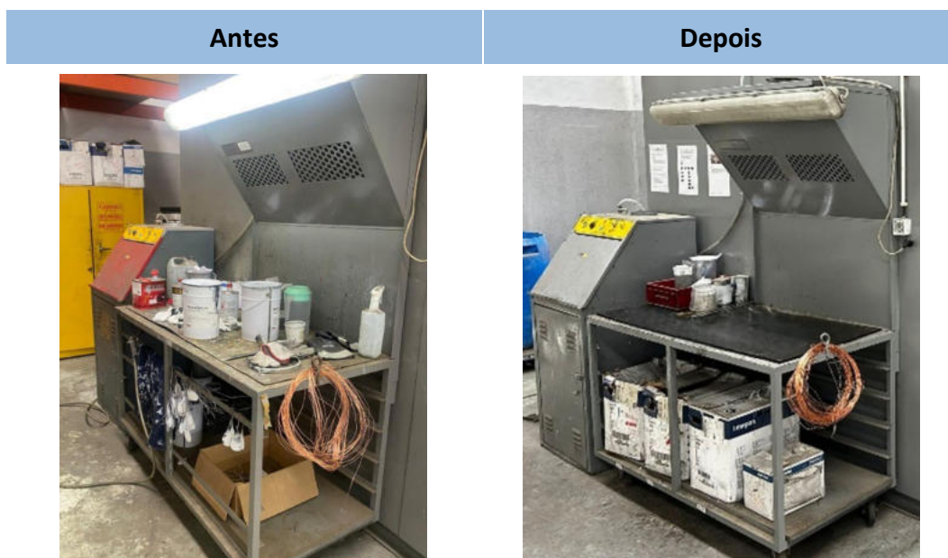
Figura 18 – Comparação entre a situação inicial na bancada de mistura de tintas e o estado de organização após aplicação dos 5S.
