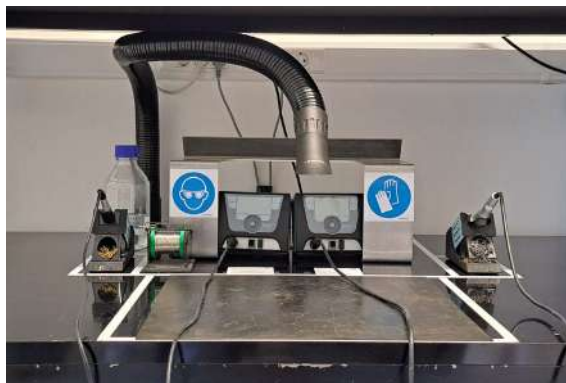
Figura 51 – Sinalética de EPI implementada na bancada de soldadura.
