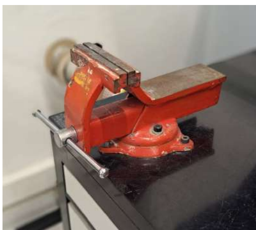
Figura 44 – Torno mecânico fixado à bancada.
