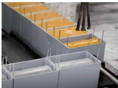
Figura 15 – Enchimento final de um condensador.
