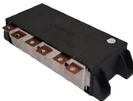
Figura 21 – Identificação do condensador de módulo de filme metalizado ao qual é realizado o teste de power dissipation .
