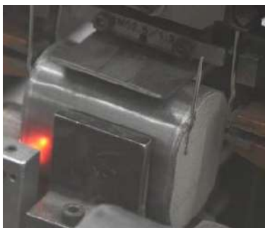
Figura 14 – Soldadura de uma bobina com quatro terminais.
