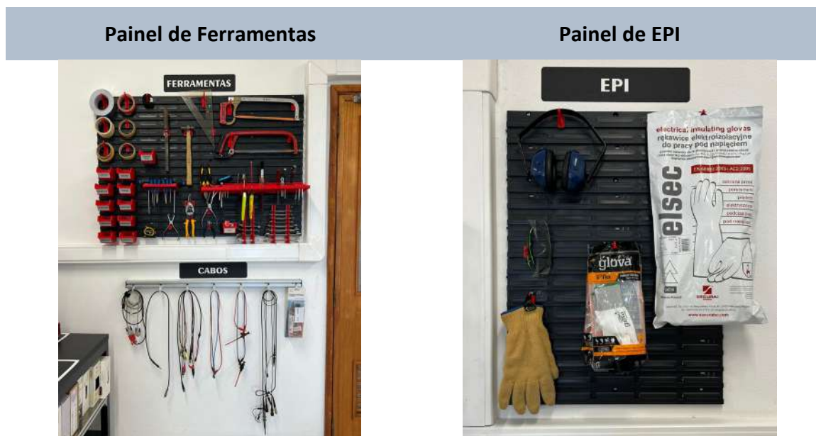
Figura 54 – Implementação de painel de parede para organização de ferramentas e EPI.
