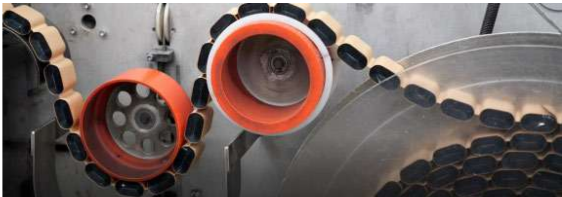
Figura 12 – Envolvimento das bobinas na pré-montagem.
