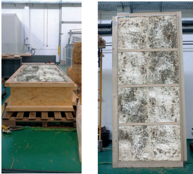
Ilustração 20 – Módulo de parede exterior pré-fabricado com isolamento de biocompósito de micélio, Reaes Pinto e Marlene Urbano.
