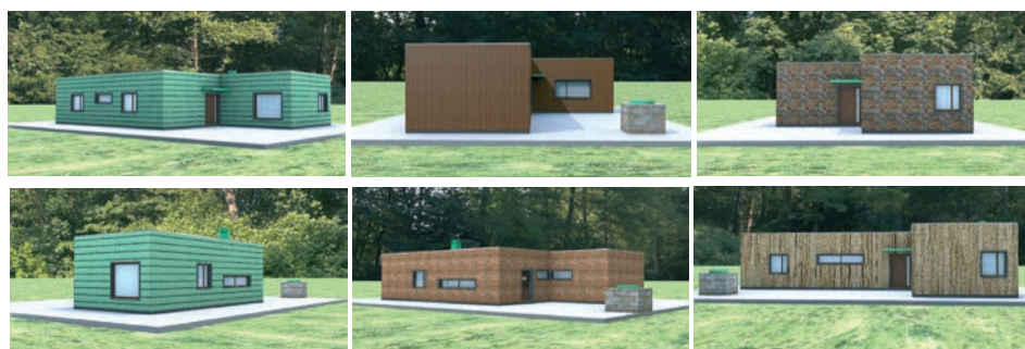
Ilustração 8 – HME: acabamentos exteriores: telha cerâmica plana, painel de régua de madeira, painel de resíduos de pedra, painel de cortiça e painel de bambu ou cana, Reaes Pinto.
