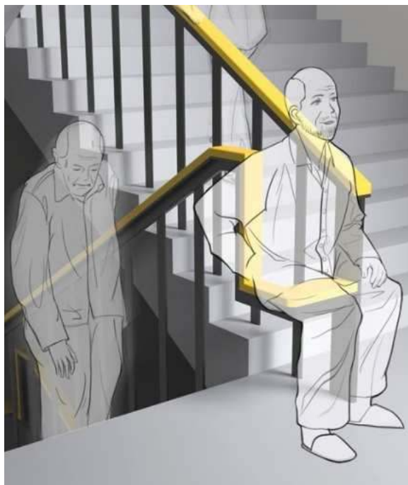
Figura 05 - Corrimãos ajustados para permitir pausas durante a subida.
