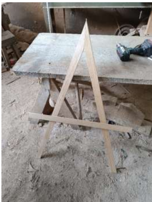
Figura 81. Ripas unidas com a utilização de cola branca e um parafuso
