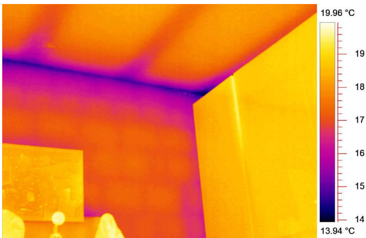
Figura 37: Ponte térmica geométrica
