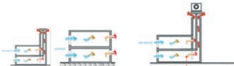
Figura 12 - Esquema Ilustrativo ventilação natural
