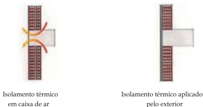
Figura 5 - Continuidade do isolamento térmico permite reduzir as pontes térmicas (European Committee for Standardization (CEN) – Eurocode 6); (IFRRU; 2020)
