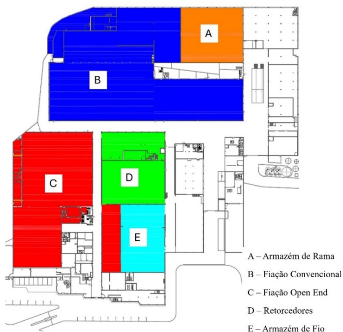
Figura 8. Layout do edifício Fiações da Felpinter.
