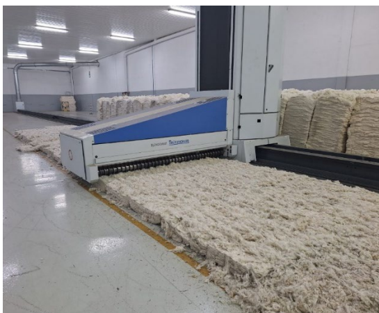
Figura 11. Ilustração do funcionamento do Blendomat.
