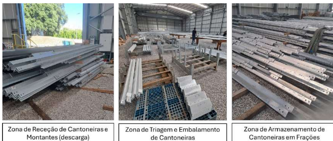
Figura 49 - Operações de receção, triagem, embalamento e armazenamento das cantoneiras no pavilhão da MTG6 reconvertido.
