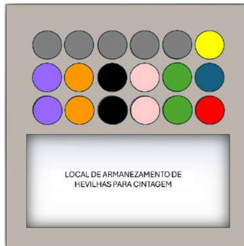
Figura 40 - Configuração da colocação das latas de spray em cada uma das bancadas projetadas.
