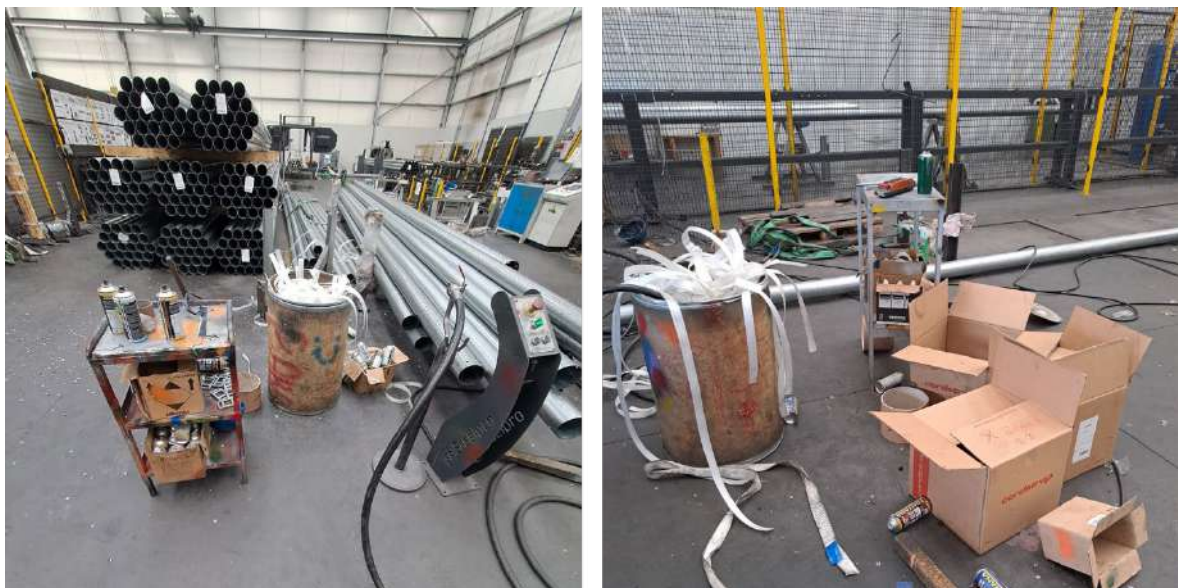
Figura 26 - Desorganização geral das bancadas de apoio à produção e embalamento dos tubos.
