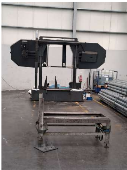
Figura 22 - Serrote usado para corte de tubos.
