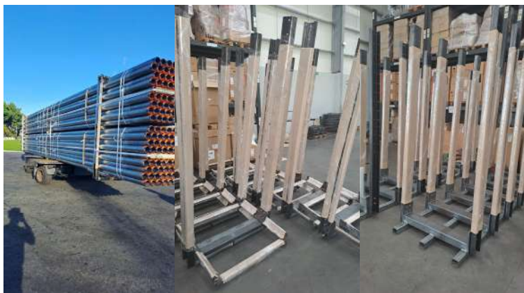
Figura 21 - Estruturas com embalagem de tubos finalizados (esquerda), estruturas de bases com rodas (centro) e estruturas de bases sem rodas (direita).
