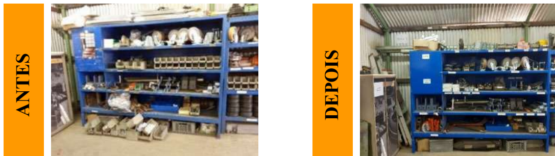
Figura 44. Comparação da situação antes e da situação depois da implementação dos 5S, relativa aos armários dos materiais gerais nos setores T5c e T6c.
