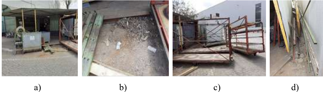
Figura 21. Zona de entrada oficina de serralharia nos setores T5c e T6c: a) desorganização na entrada; b) resíduos depositados no pavimento na entrada; c) carrinhos de transporte de pneus a ocupar a via de circulação; d) local inadequado para depositar materiais de ferro.
