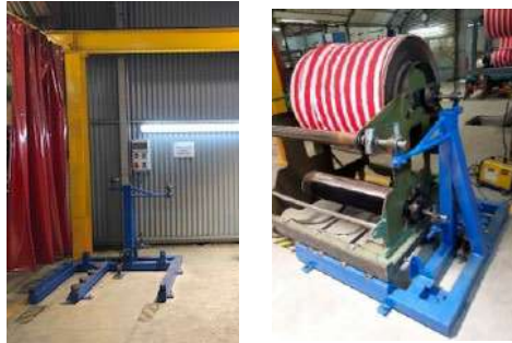
Figura 66. Processo de cassetes de breacker no gabari nos setores T5c e T6c.
