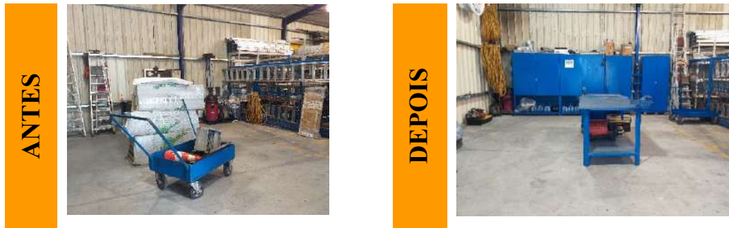
Figura 37. Comparação da situação antes e da situação depois da implementação dos 5S, relativa ao layout nos setores T3c e T4c.
