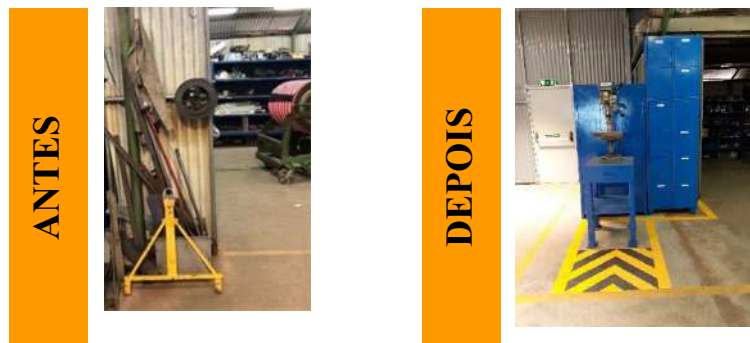
Figura 102. Comparação da situação antes e da situação depois da implementação dos 5S, relativa à vista do aumento da oficina e aos cacifos nos setores T5c e T6c.
