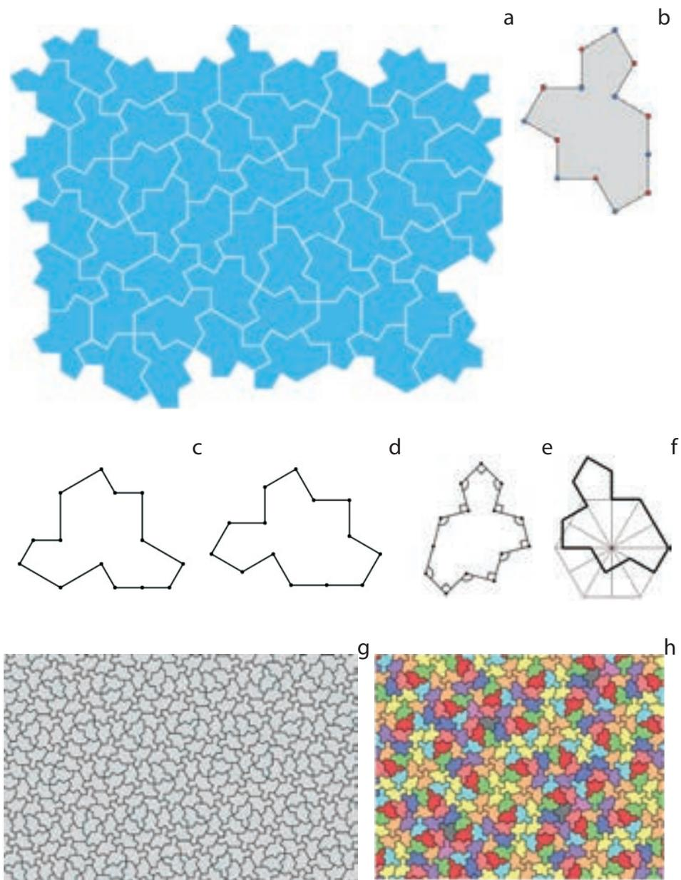
**Figura 10** - O monoladrilho "spectre"; a) apenas um ladrilho, sem reflexões; b) a distância entre os pontos é sempre igual, ao contrário do caso do hat; c) comparação "hat" vs. d) "spectre"; e) ângulos de 90 e 120°, apenas, no "spectre"; f) como o "spectre" assenta num hexágono regular; g,h) as peças encaixam todas mas não há periodicidade, o que torna a figura sempre diferente, o que confere uma característica de ausência de "monotonia" à estrutura.
