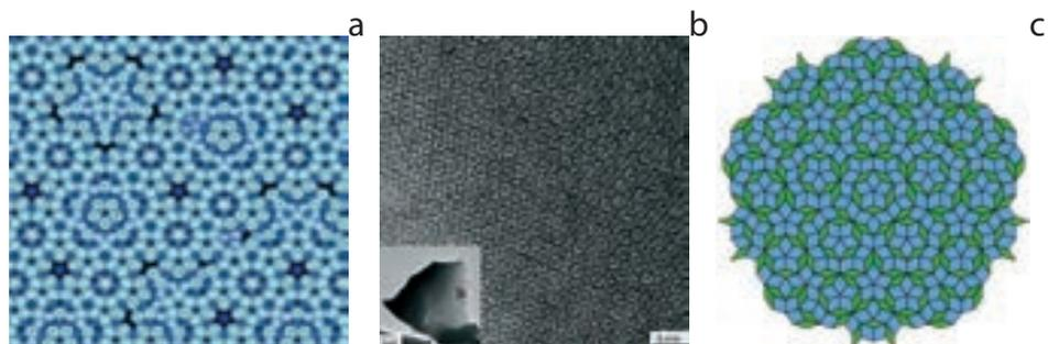
**Figura 7** - a) Estrutura de um quasicristal de alumínio–paládio–manganês. b) Imagem de microscopia electrónica de transmissão de um quasicristal natural detectado no meteorito de Khatyrka; c) Pavimentação de Penrose.
