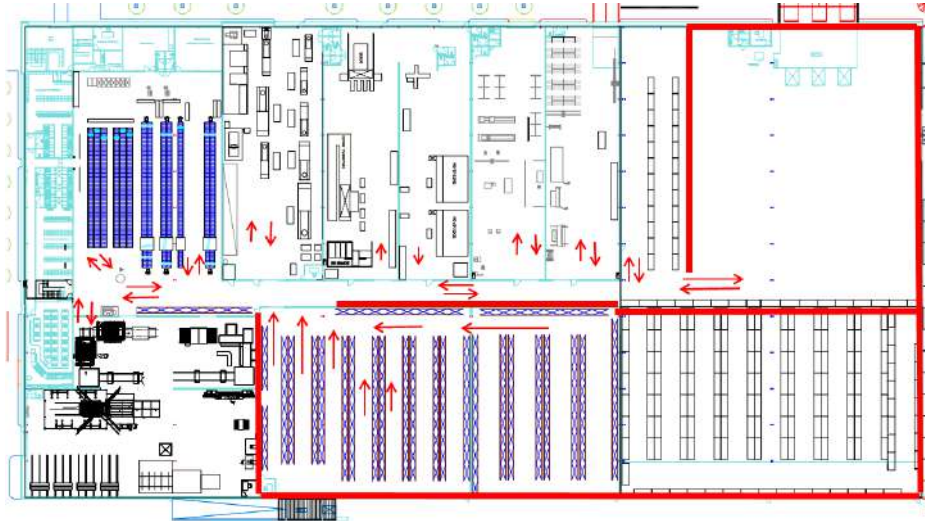
Figura 21. Armazéns e fluxos de materiais
