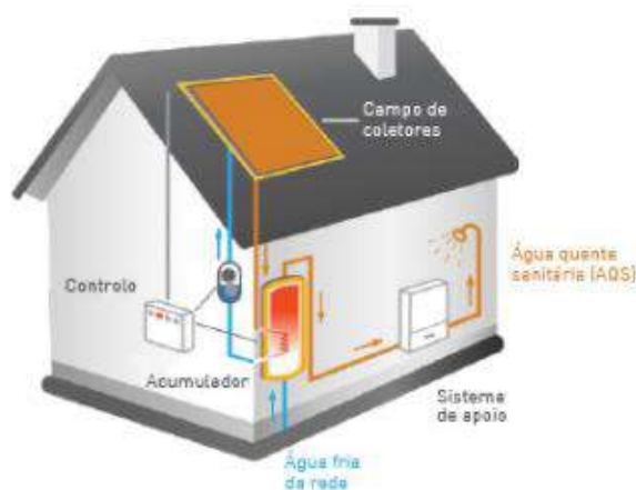
Figura 12 - Sistema de Circulação Forçada
