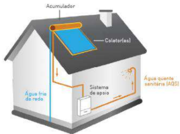
Figura 11 - Sistema compacto de Termossifão
