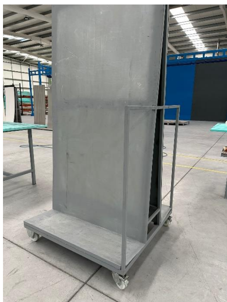
Figura 30: Carrinho de auxílio ao transporte manual
