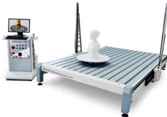
Figura 21: Máquina de corte de fio quente para o processo de corte na GHP360.
