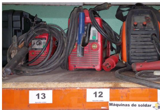
Figura 37 – Equipamentos de soldadura no local de armazenagem
