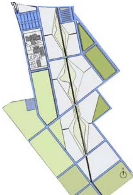
Ilustração 96 - Diagrama representativo das vias de circulação e estacionamento na zona norte do plano. (Ilustração nossa, 2013)
