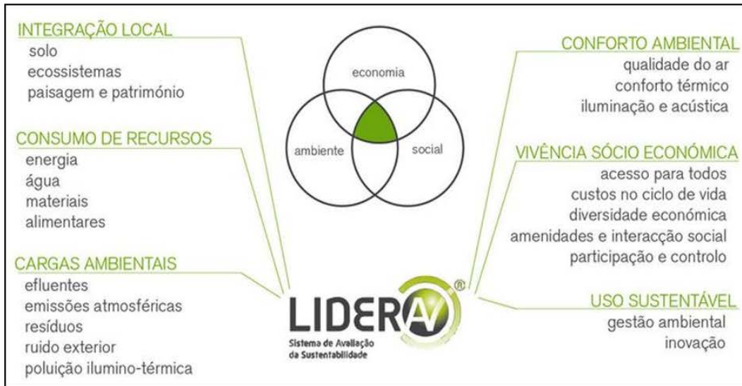
Ilustração 30 - Diagrama com as seis vertentes e as vinte e duas áreas do sistema LiderA. (Fonte: LiderA, 2011).
