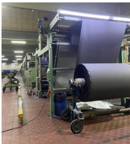
Figura 17 - Equipamentos usados no acabamento (râmolas).
