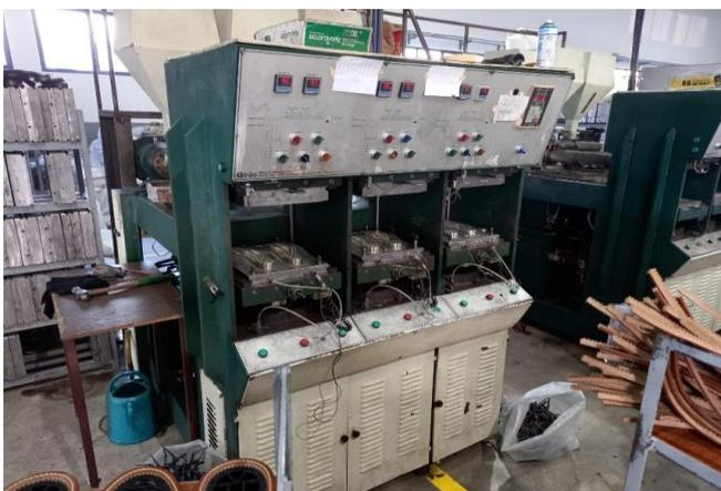
Figura 3- Máquina de injeção termoplástico (TR)
