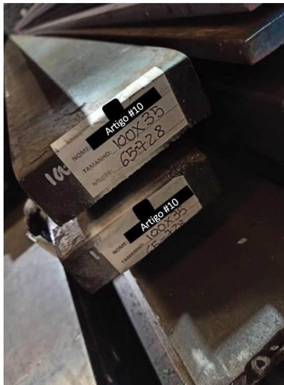
Figura 32. Etiqueta autocolante para identificação de barras.
