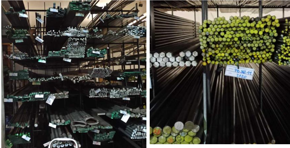
Figura 33. Etiqueta plastificada para diâmetros inferiores a 20 mm.
