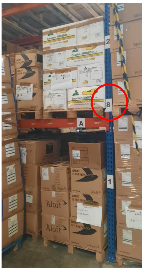
Figura 22 - Identificação inadequada de estante.
