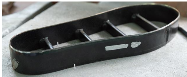
Figura 21 – Molde cortante para modelo de sapato.
