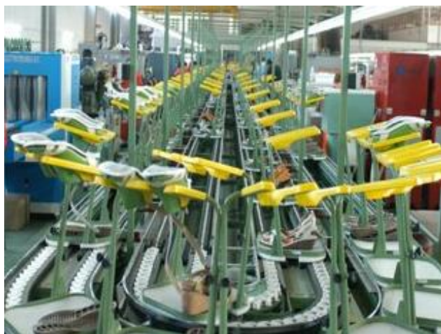
Figura 23 – Linha transportadores manual (montagem).
