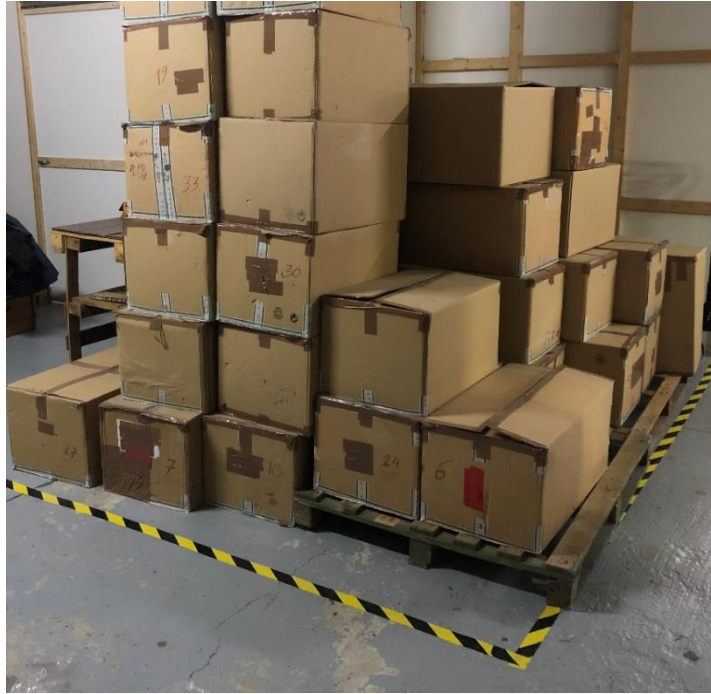
Figura 40 – Delimitação de áreas (armazém de PA).
