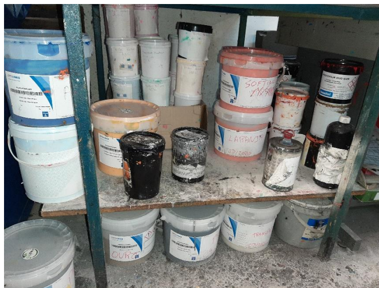
Figura 34. Produtos com identificação pouco visível e em mau estado de conservação.
