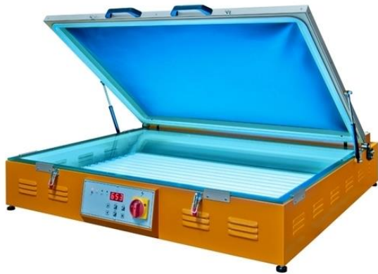
Figura 20. Prensa de serigrafia (Acosgraf, 2019).
