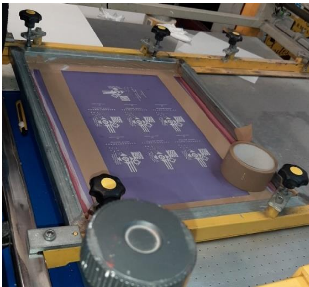
Figura 19. Tela de serigrafia colocada na máquina de impressão.
