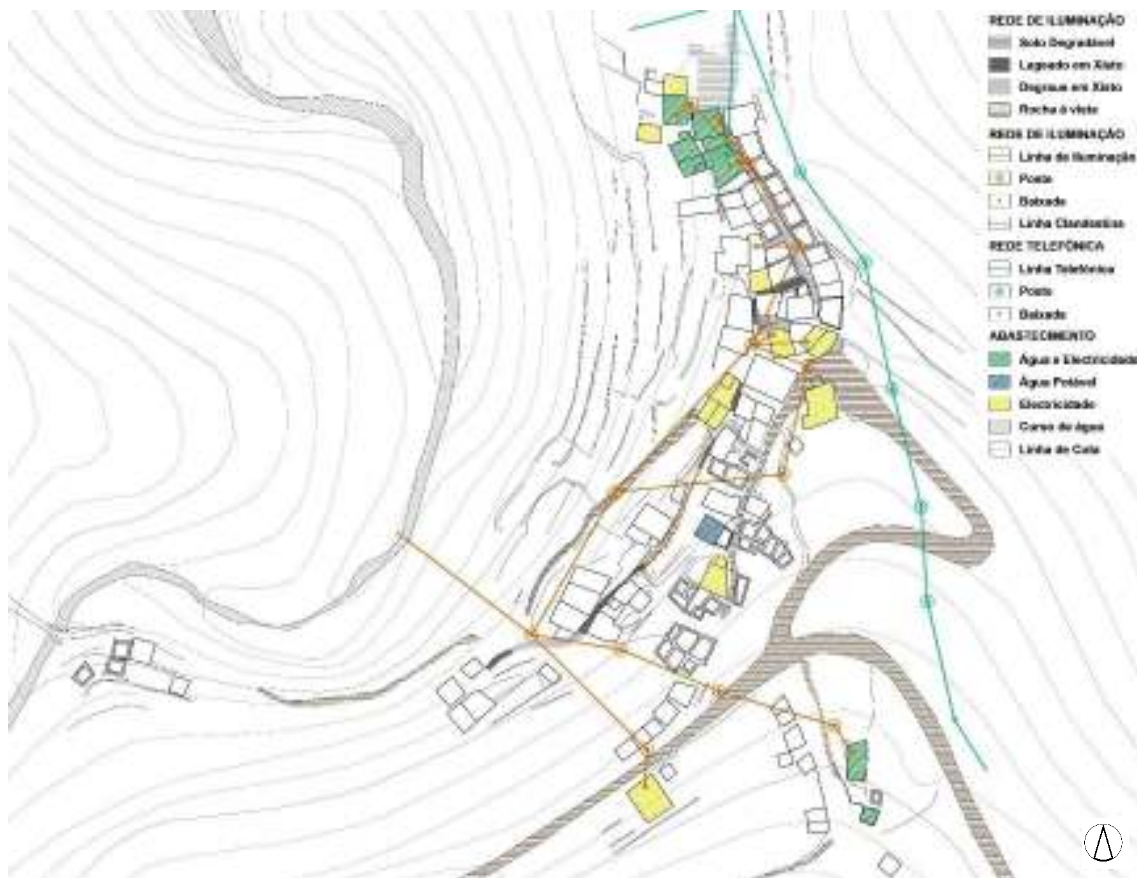
Fig. 37 Planta de infraestruturas existentes, escala gráfica
