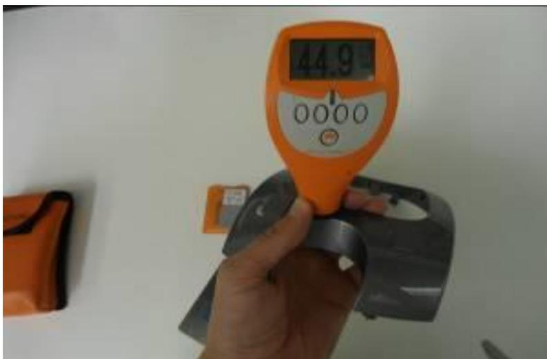
**Figura 27:** Medidor de Espessuras – Elcometer da Apoloblue
