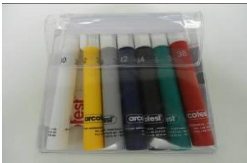
**Figura 30:** Canetas Medição Tensão Superficial da Apoloblu
