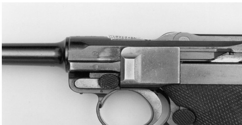
Fig. 19 - Pormenor da inscrição em português no extractor da pistola Parabellum m/908.
