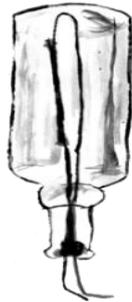
**Ilustração 13** - O design incandescente original de Heinrich Göbel, estava contido num frasco de vidro. (IES, 2011)
