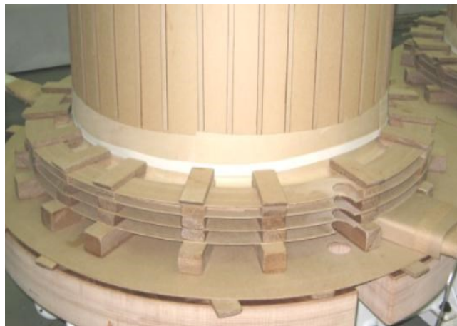
Figura 20: Calços e isolamento [31].
