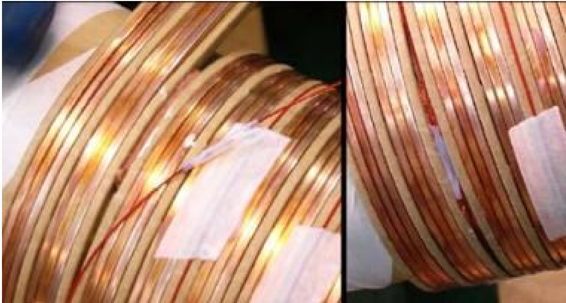
Figura 66: Sensor de fibra óptica instalado nos enrolamentos [81].
