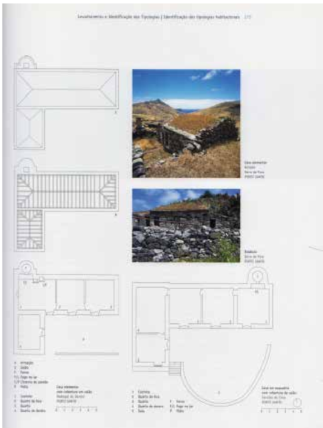
Ilustração 285 – Casa elementar com cobertura de salão e casa em esquadria com cobertura de salão. (Mestre, 2001 p. 173).
