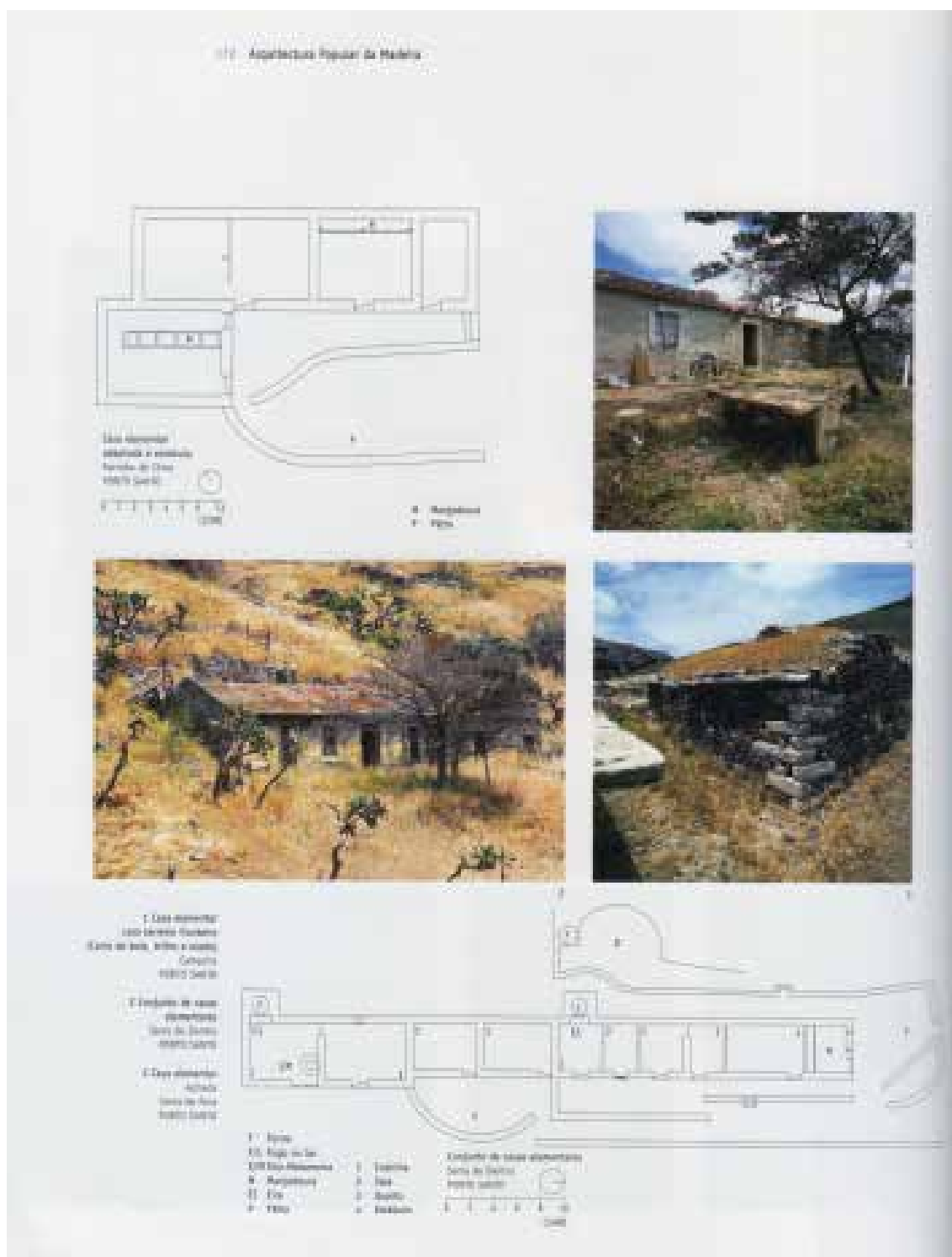
Ilustração 284 – Casa elementar adaptada a estábulo e conjunto de casas elementares com cobertura de salão. (Mestre, 2001 p. 172).
