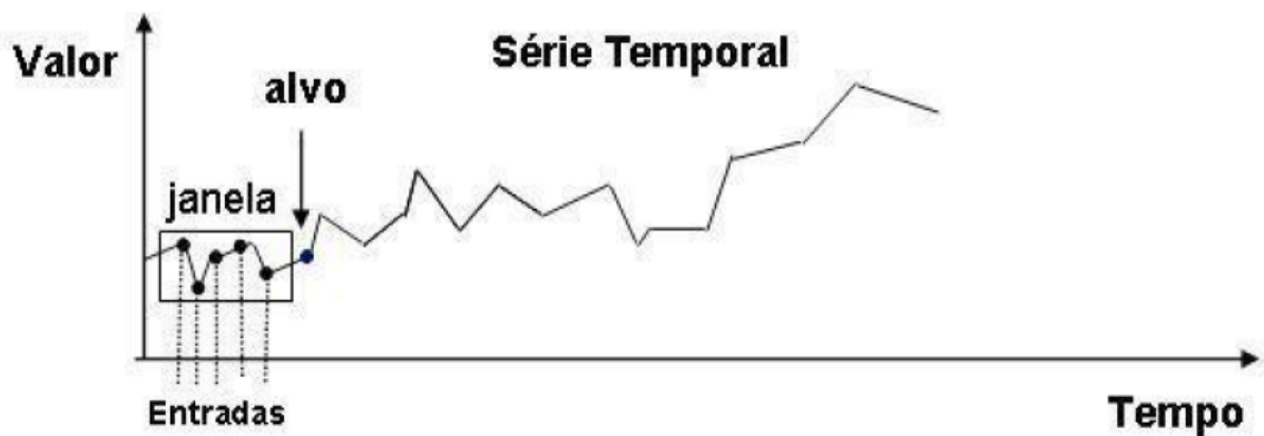
Ilustração VII – Exemplo de uma janela de previsão com cinco entradas e horizonte de previsão igual a um [Moretin & Tolo. 2009]
