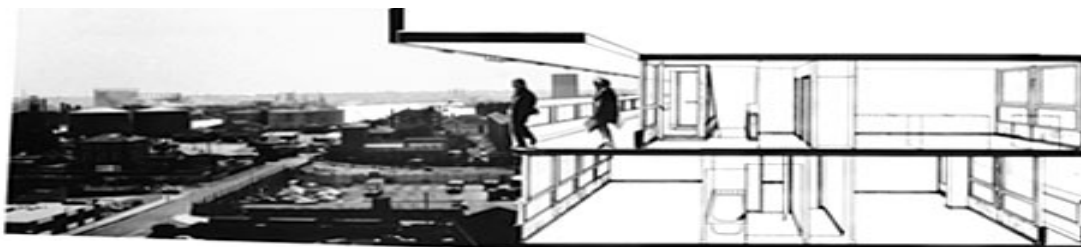
Ilustração 40 – Corte transversal representativo das streets in the sky (Londres, Inglaterra), projeto dos Arqts. Smithsons. (Heuvel, 2013, p. 363)
