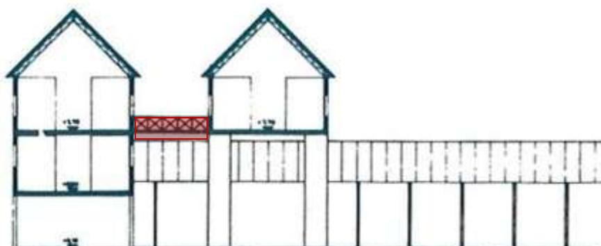
**Ilustração 124** - “Corte transversal do edifício do columbário e da colunata”, ligação feita por pontes metálicas no último piso, Aldo Rossi. ([Adaptado a partir de : ] Arnell, Bickford, 1985, p. 96)
