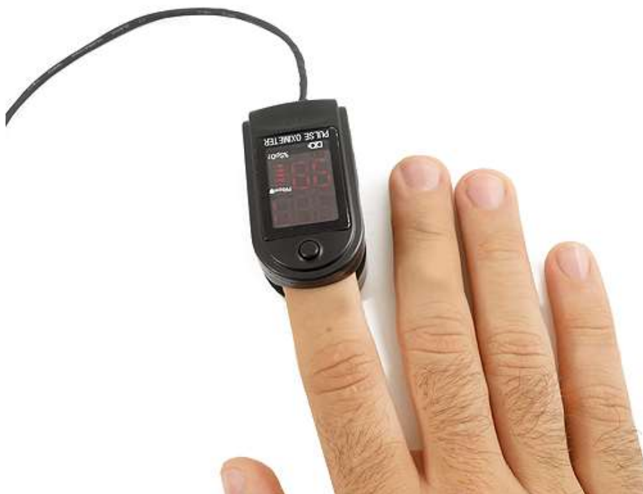
Figura 26: Obtenção de valores no oxímetro [18].
