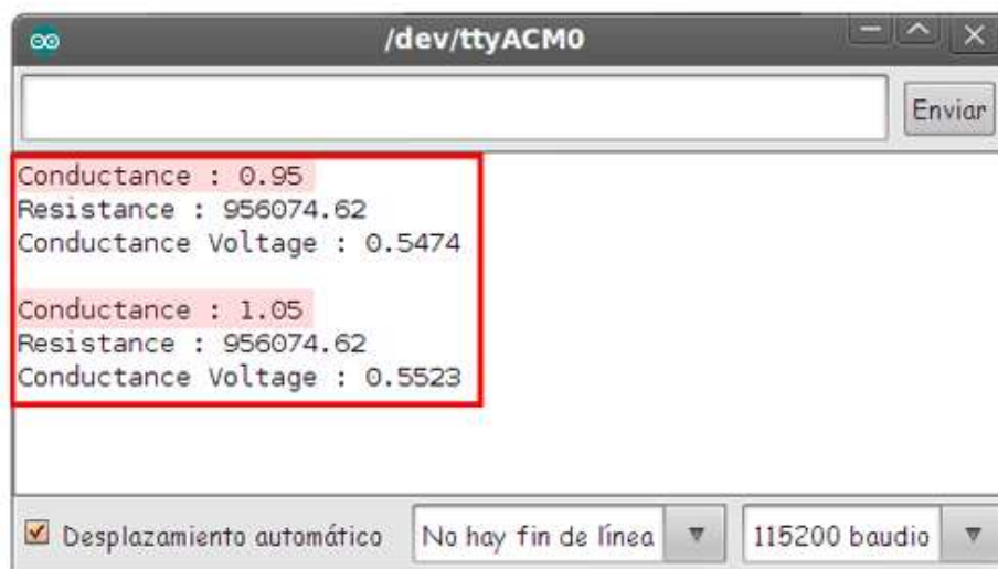
Figura 38: Obtenção dos valores da RGP através do serial monitor [18].
